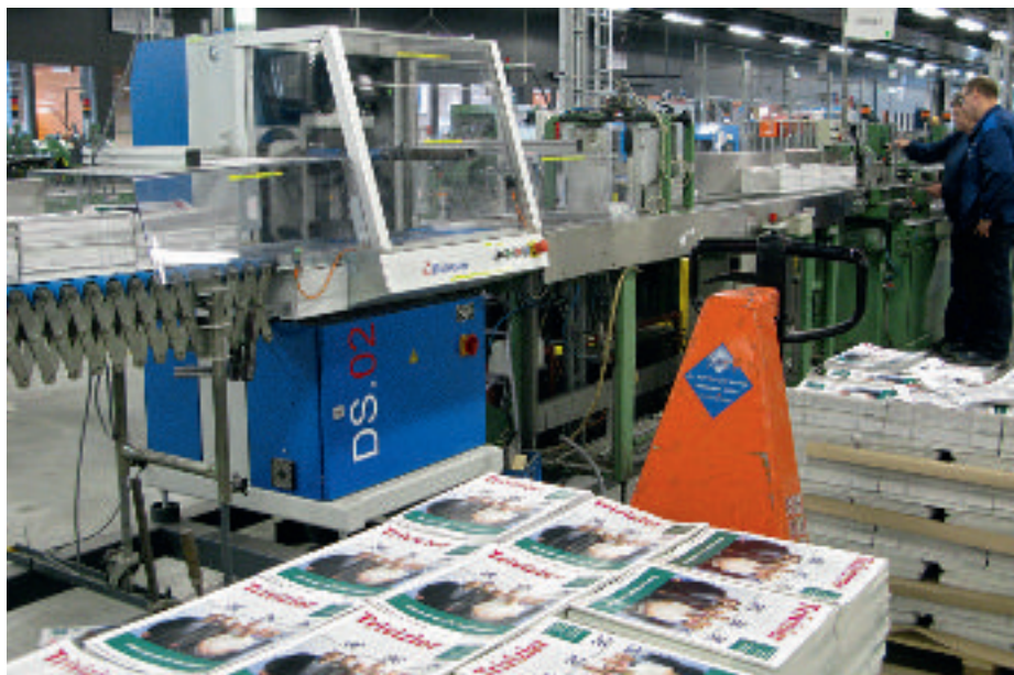
De stapelkeerder staat op een frame, zodat hij van de ene lijn naar de andere verplaatst kan worden.
